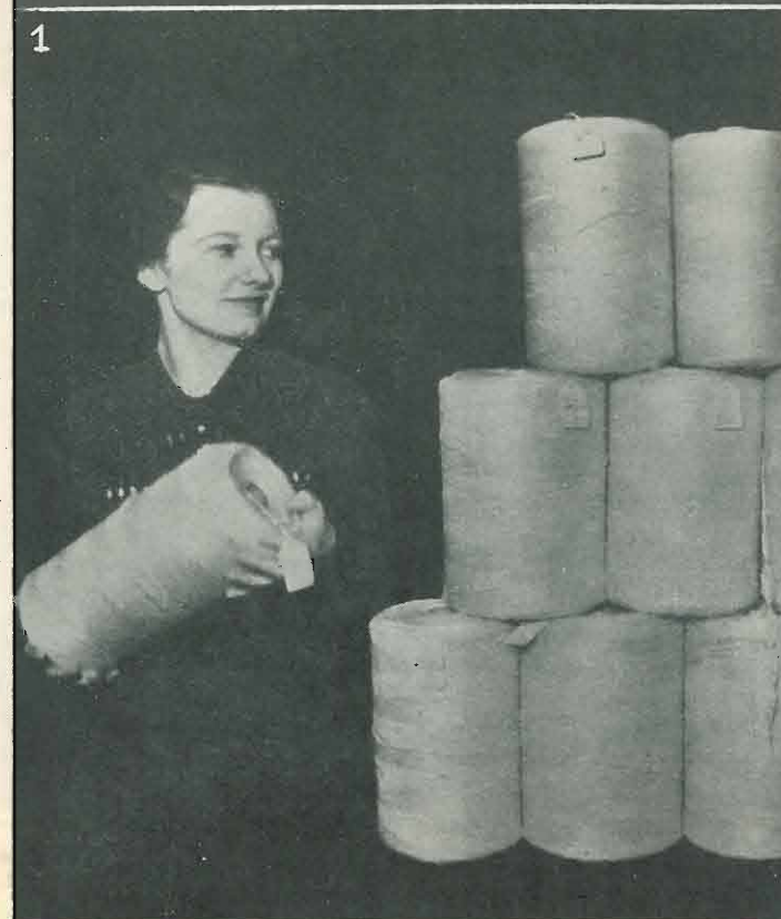
Fig. 1. Pezze di tessuto fatto di lana di vetro; esso è sottilissimo, resistente, leggero e non è infiammabile.
